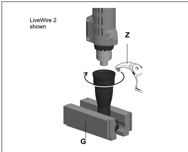
Fig. 10-1: Disassembling gear
