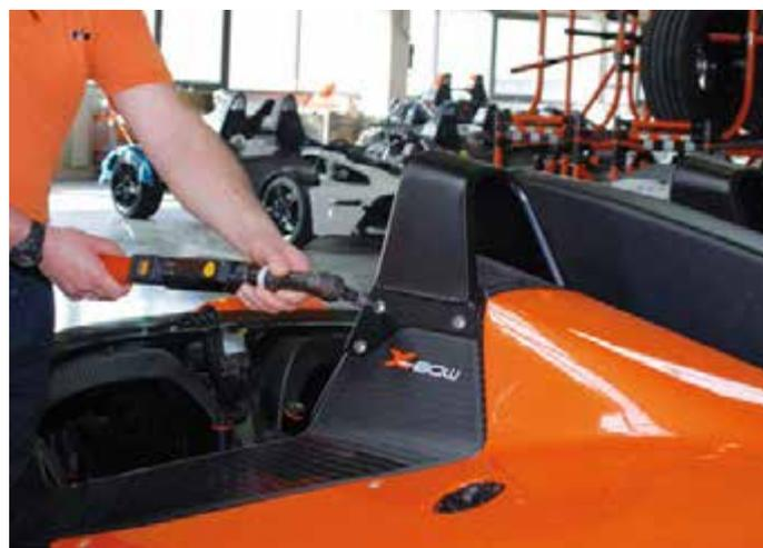
Les outils d'assemblage LiveWire de Cleco chez le constructeur de voitures de sports autrichien KTM, à Graz. Visseuses d'angle et pistolet LiveWire et une clé dynamométrique électronique sans fil sur un seul contrôleur. Productivité sans fil pour tous les assemblages critiques sur la voiture de sport Premium X-Bow.
