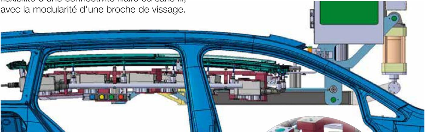
Conçu pour une application unique avec des problèmes de passage. Les LiveWire Mini-Spindles élimine les agencements complexes et l'extension des câbles généralement associés sur des applications de broches de vissage.
