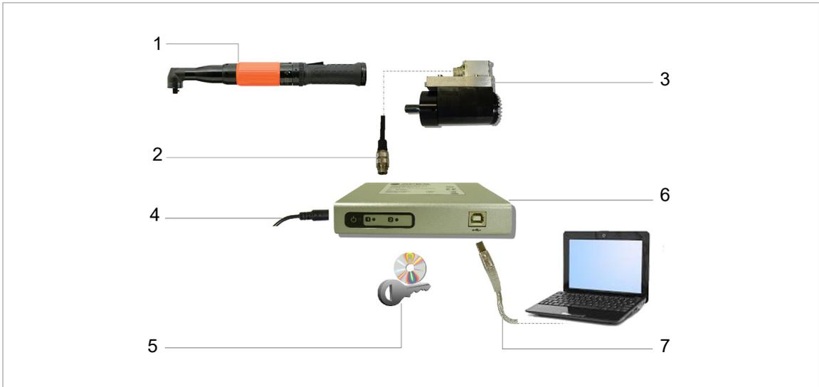
Abb. 4-1: Systemaufbau Serie 17/47/18/48 und Serie BB/BTS(E)/BD (seriell)/BTSi (seriell)
