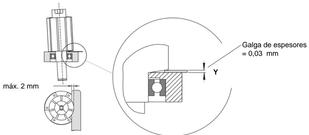
2. Comprobar Y con la galga de espesores. Si la medida es > Y, repetir el paso 1 con la base <C5>, <C6>, <C7>.
