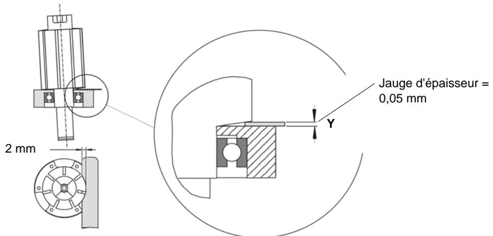
2. Vérifier Y à l'aide de la jauge d'épaisseur. Si la cote est > Y, répéter l'étape 1 avec <C5>, <C6>, <C7>.
